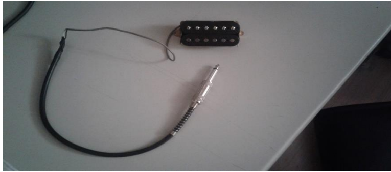
Şekil 3: Elektrik gitar manyetiği ile tasarlanmış bir circuit sniffing ünitesi (Tasarım: Arda EDEN)
