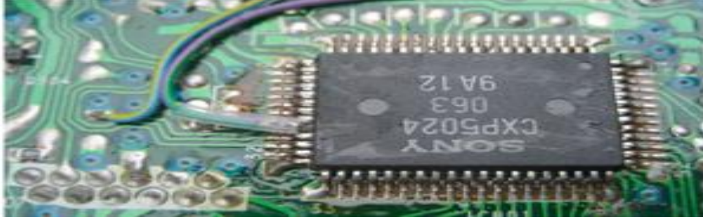
Şekil 2: Sony D2 Discman üzerinde mute (sesi kısma) özelliğinin çip üzerinden kaldırılması 70
