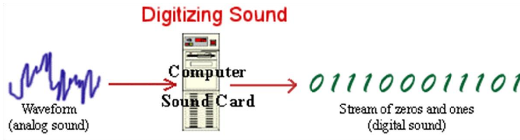
Şekil 2. Sesin analogtan dijital dönüşümü (Ya-Ping Hsieh, 2015: 2)
