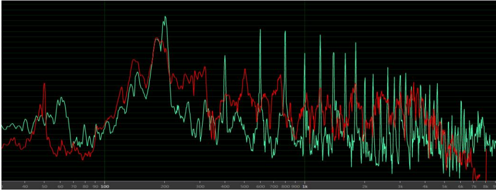
Şekil 3.7 Ses tablasının güçlü titreşim modu etkisiyle temel sesteki bozulma
