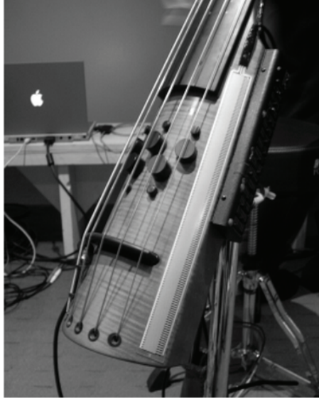
Şekil 2. Kontrbasa yerleştirilmiş elektronik sensörler (Miranda and Wanderley, 2006, 23)
